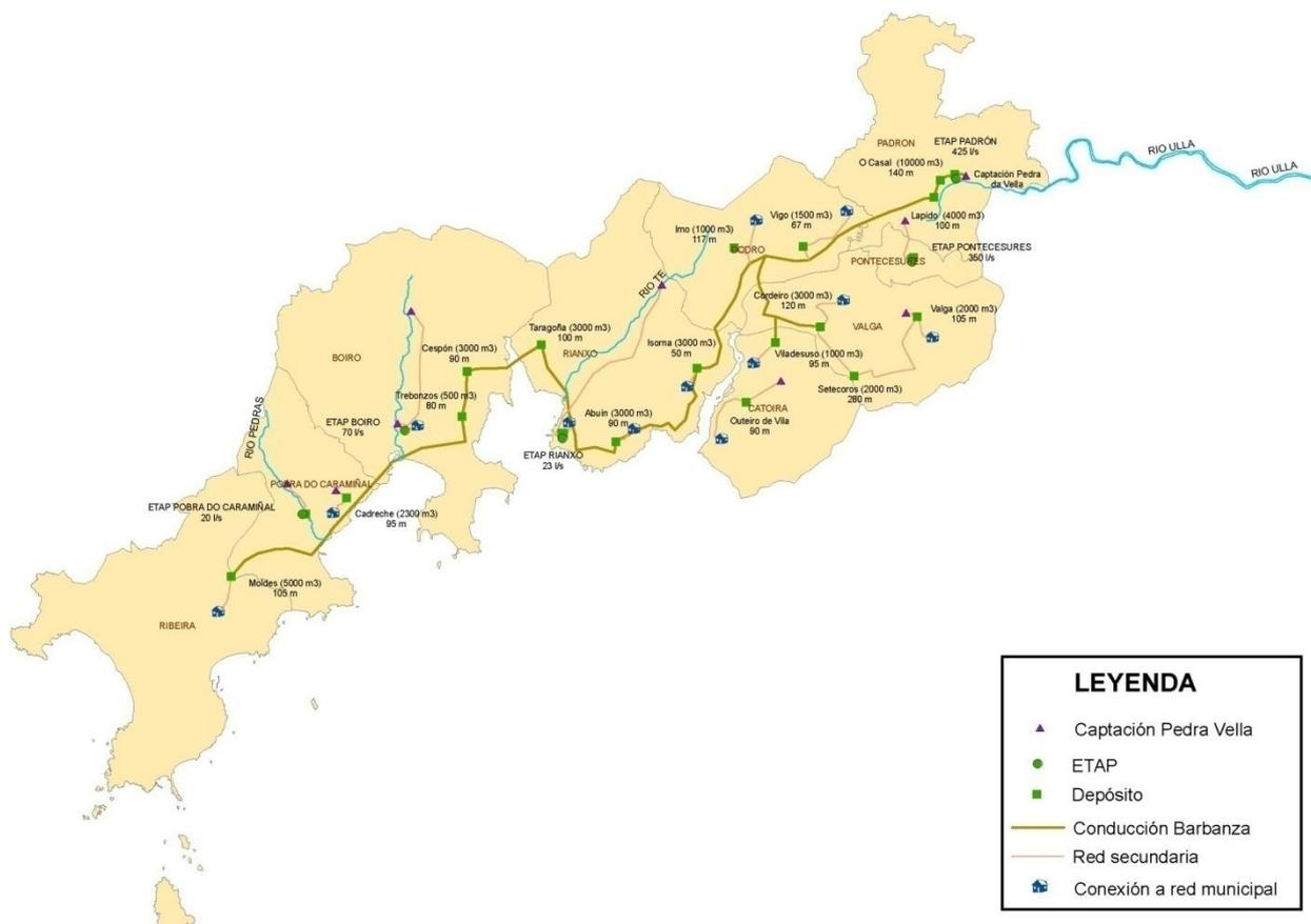
Figura 68. Esquema general de la red de abastecimiento del sistema del Barbanza.
