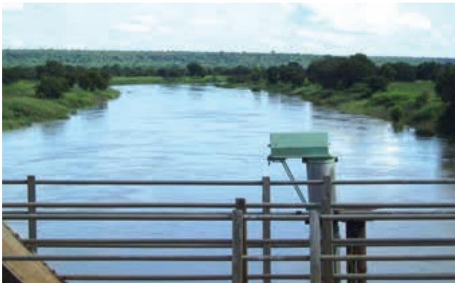
*Dispositivo registrador automático del nivel del agua*
