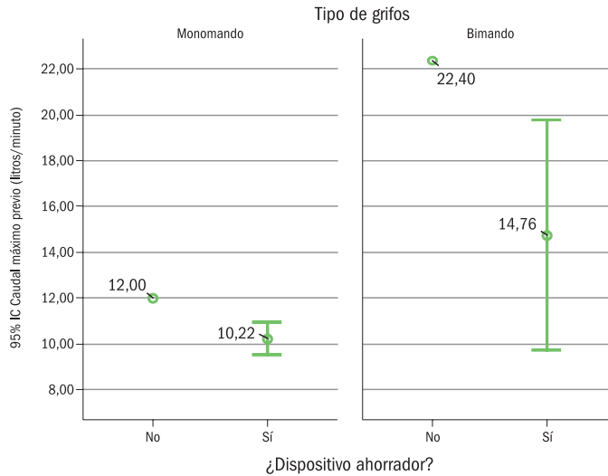
Figura 3.38: Caudal máximo medio de los grifos de los fregaderos según su tipo antes y después de intervenir sobre el dispositivo ahorrador
