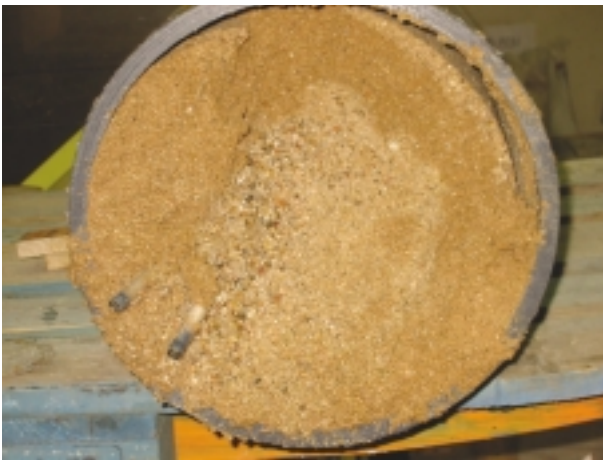
FOTO 2. Disposición concéntrica de dos terrenos (una vez desmontado el ensayo).
