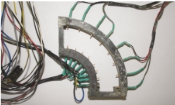
FOTO 3. Dispositivo de medida del potencial eléctrico.
