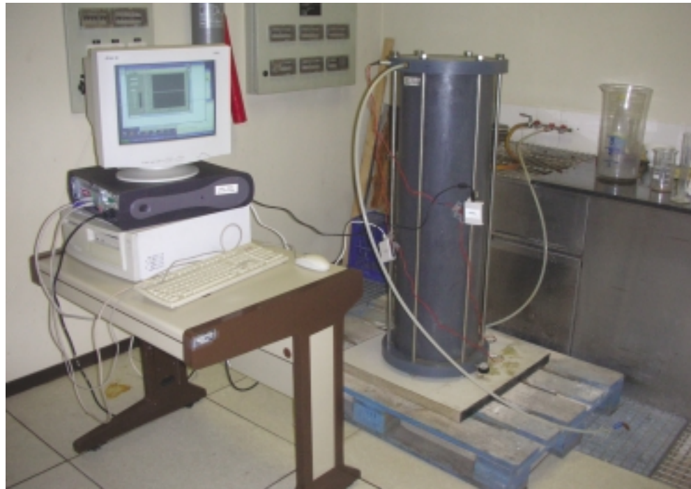
FOTO 1. Equipo empleado en los ensayos: Cilindro de PVC (derecha) y sistema de adquisición de datos (izquierda).
