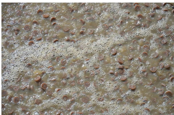
FIGURA 2. Detalle del licor mezcla y el soporte móvil de biomasa.
