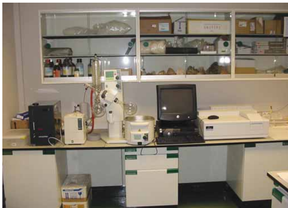
FIGURA 4. Columna de rotación y espectrofotómetro de doble haz (C.E.H).
