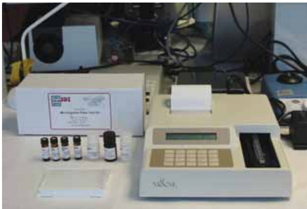
FIGURA 6. Determinaciones de microcistinas mediante ELISA (C.E.H).
