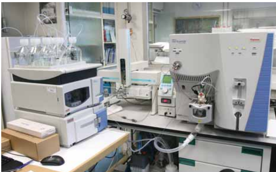
FIGURA 7. Determinaciones de microcistinas por HPLC/MS/MS (C.E.H).
