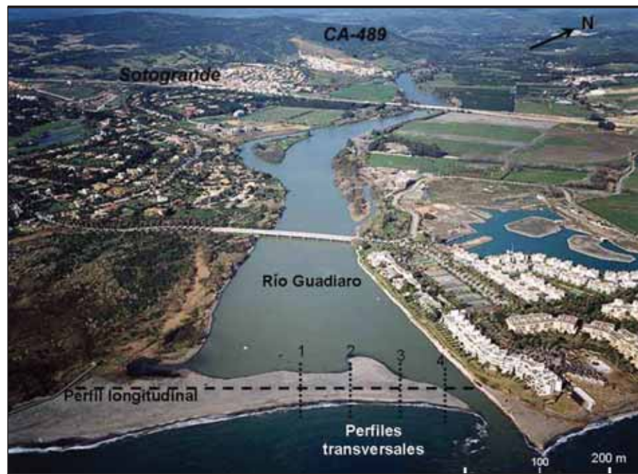
FIGURA 4. Representación de los perfiles longitudinal y transversales en la flecha.
