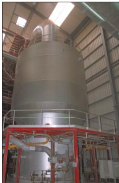
Hornos de lecho fluidizado de la planta de aguas residuales de La Cartuja.
