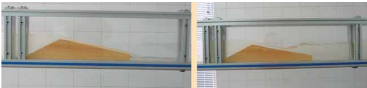
FIGURA 8. Izquierda: modelo reducido en el que se observa un salto en el truncado y el resalto tras el paramento de aguas abajo. Derecha: paramento con el truncado anegado y el cachón formado sobre éste (situación preferible para los peces).
