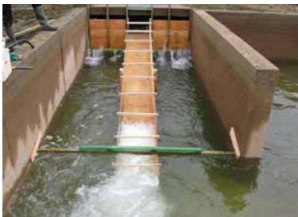
FIGURA 13. Modelo reducido de estación de aforos construido para evaluar la capacidad natatoria de los peces ibéricos.
