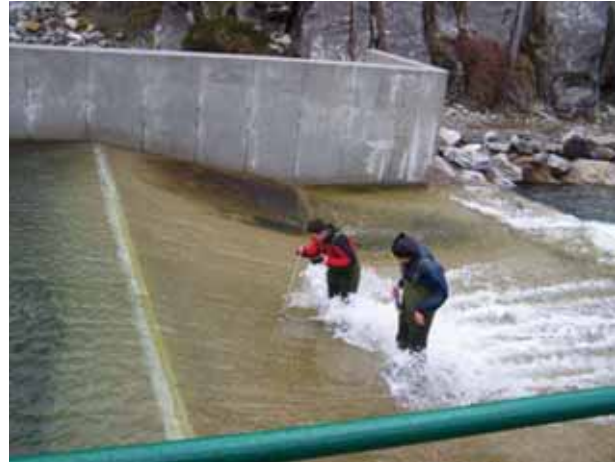
FIGURA 3. Medición de la velocidad en una estación de aforos de tipo V-flat con molinete hidráulico.
