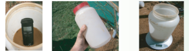
٤- نكمل الوزن بالماء الممطر حتى ٥٠٠ غم ٥- نحرك المزيج بقوة لمدة ٤ دقائق ٦- نقيس طويحة المزيج باستخدام جهاز الملوحة المحمول
