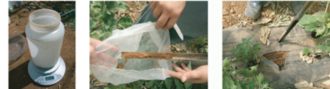
١- تؤخذ عينة ممثلة للتربة الحقل ٢- نخلط عينة التربة جيداً ٣- نوزن ١٠٠ غم من عينة التربة
