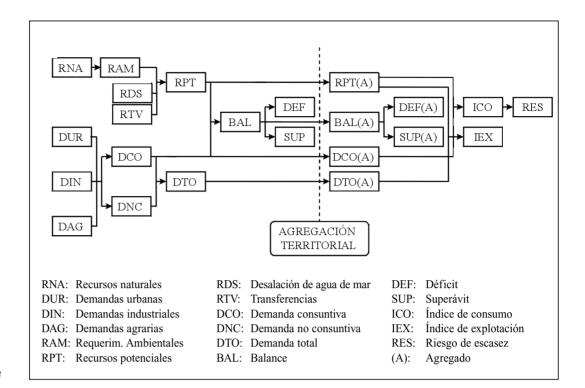
Figura 266. Modelo cartográfico del sistema de utilización
