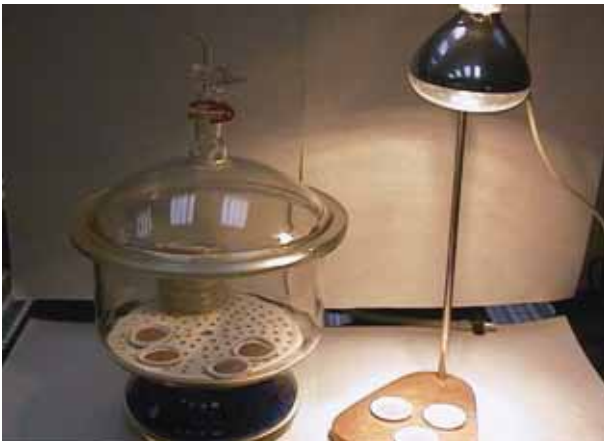
FIGURA 2. Método de coprecipitación de emisores alfa.
